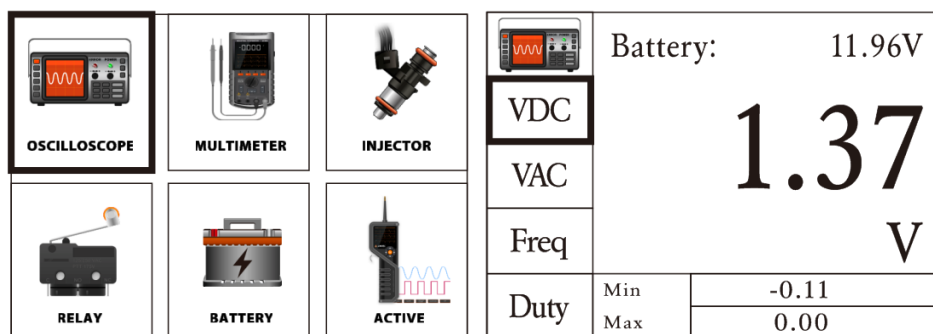
Obrázok 3 – Hlavná ponuka a meranie jednosmerného napätia
