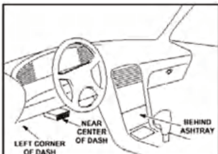
Obrázok 2: Typické umiestnenie konektora DLC v interiéri vozidla.
