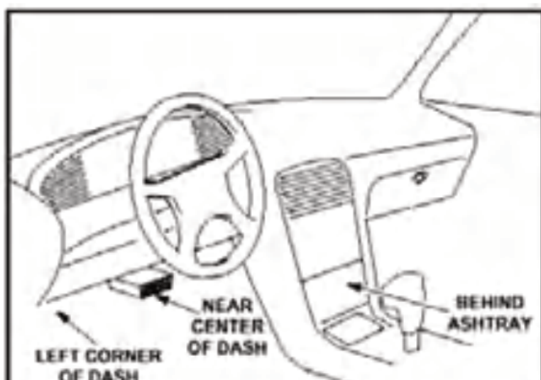
Obrázek 2: Typické umístění konektoru DLC v interiéru vozidla.
