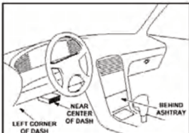
2. ábra: A DLC csatlakozó tipikus helye a jármű belterében.
