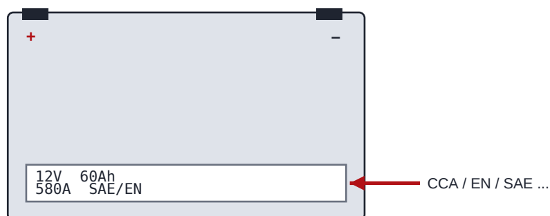
Ábra: Az akkumulátor szabványa és névleges értéke (pl. 12 V, 60 Ah, 580 A / SAE/EN) az akkumulátor címkéjén található — a nyíllal jelölt helyen.
