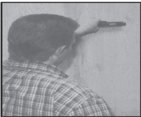
(Bal oldali kép) A GP-POINTERrel történő falszkenneléshez használja az oldalsó szkennelési technikát a nagy területek gyors lefedéséhez.
