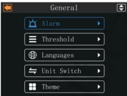
**Preklapljanje enot:** Za spreminjanje enot uporabite gumba gor/dol, ni treba pritisniti gumb V redu.
