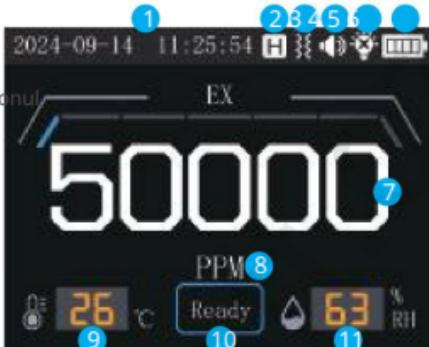
4. Buzzer de alarmă: Indică dacă funcția de alarmă este activată
